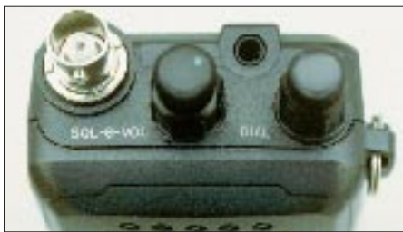
Icoms IC-R10 bietet noch echte Drehsteller für Lautstärke und Rauschsperr.
