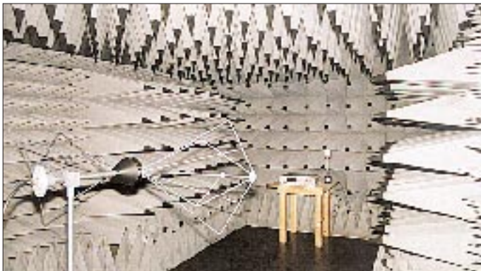
Blick in die Absorberhalle eines Prüflabors. Im Vordergrund die bikonische Antenne HK 116 von Rohde & Schwarz, im Hintergrund ein Prüfling (EUT = Equipment Under Test) sowie ein isotroper Feldstärkensenor mit optischer Schnittstelle
