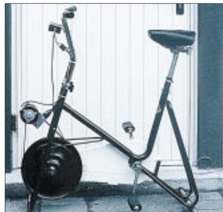
Der zum Tretkurbelgenerator umgebaute Hometrainer Foto: DJ3RW
