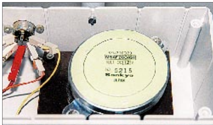
Bild 2: Der Schrittmotor findet in einer Kunststoffbox Platz.
