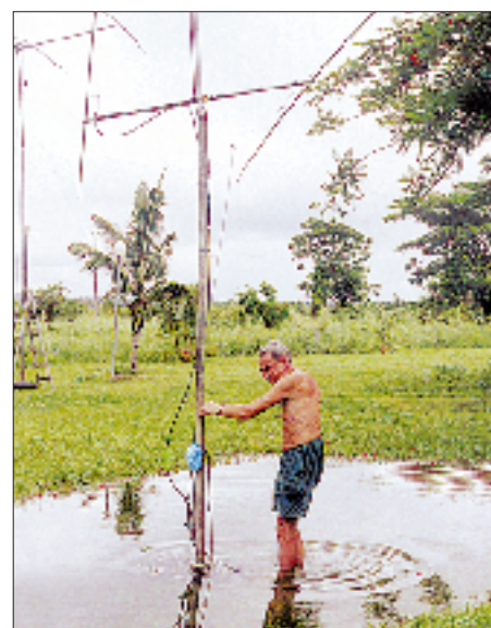
Gute Grund-Leitfähigkeit verbessert den Antennenwirkungsgrad, hier für 5W0VD & Co. in Apia. Fotos: OK1TN
