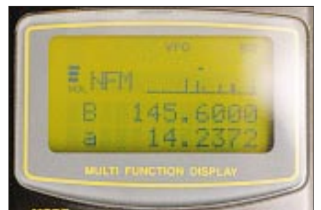
Display des DJ-X10 mit der Scope-Darstellung
