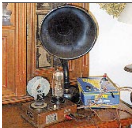
Bild 1: Die komplette Empfangsanlage mit OE-333, Anodenbatterie, Heizakkumulator und Trichterlautsprecher
